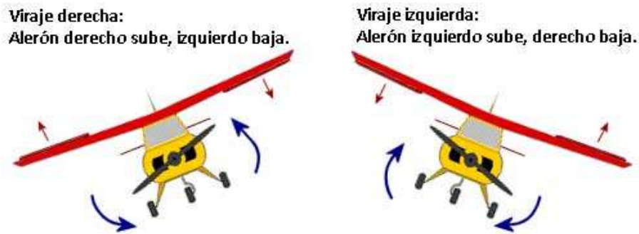
Figura 29: Il·lustració del gir controlat pels alerons.
