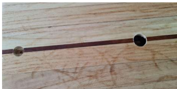
Figura 50: Forat de la vàlvula i el leash plug (esquerra) i accessoris implantats (dreta) (elaboració pròpia).
