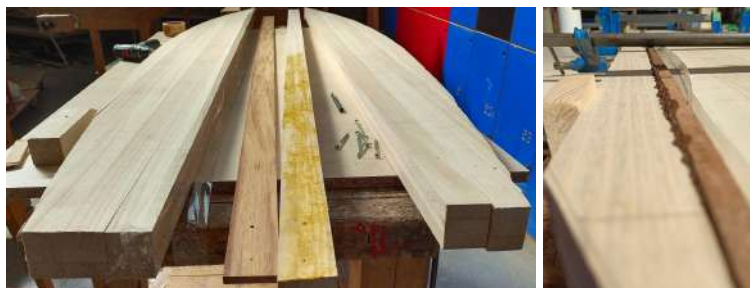
Figura 39: Intent d'enganxar els dos llistons amb poliuretà (esquerra) i llistó enganxat (dreta) (elaboració pròpia).
