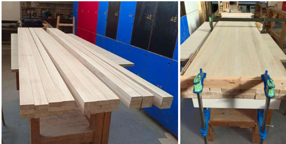
Figura 36: Llistons de paulownia acabats de comprar (esquerra) i fusta fixada amb serjants (dreta) (elaboració pròpia).
