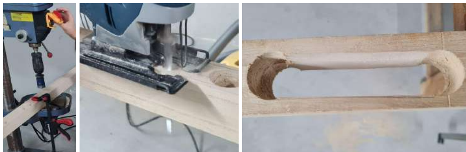
Figura 41: Foradant (esquerra), tallant (mig) i el forat acabat (dreta) (elaboració pròpia).
