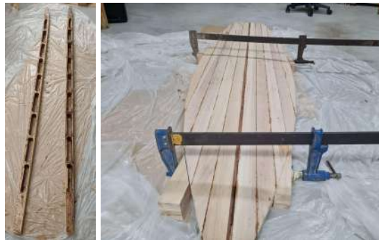
Figura 45: Dos llistons encolats i preparats per enganxar-se (esquerra) i taulons assecant-se (dreta) (elaboració pròpia).
