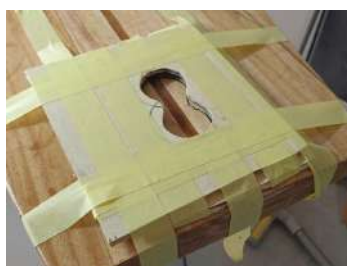
Figura 49: Motlle del caixetí de la quilla central posat sobre la taula de surf (elaboració pròpia).
