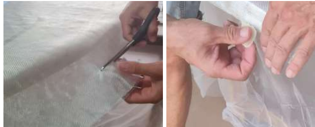
Figura 47: Retallant la fibra escurant força (esquerra) i fixant-la amb cinta de pintor (dreta) (elaboració pròpia).
