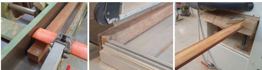
Figura 38: Obrant, escairant i regruixant (elaboració pròpia).
