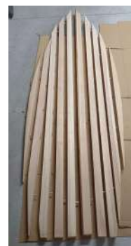
Figura 43: Taula de surf desmuntada amb tots els torellons implantats (elaboració pròpia).
