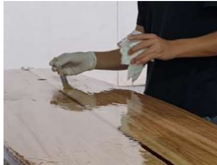
Figura 51: Envernissat de la taula (elaboració pròpia).
