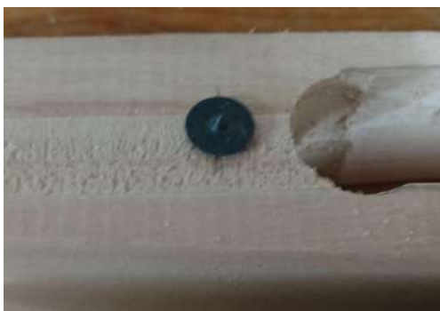
Figura 42: Centrador preparat per fer un forat perfectament alineat en la fusta adjunta (elaboració pròpia).
