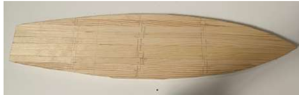
Figura 24: Marcatge de la silueta de la taula en els llistons (elaboració pròpia).
