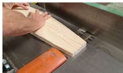
Figura 26: Creant la curvatura necessària en la part de sota de la taula a la màquina d'obrar (elaboració pròpia).
