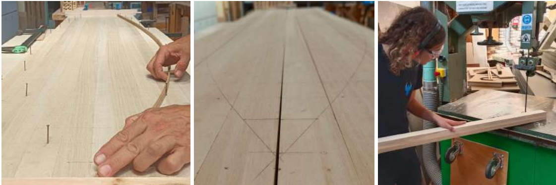
Figura 37: Llistó elàstic marcant la curvatura del contorn de la taula (esquerra i mig) i tallatge de la fusta (dreta) (elaboració pròpia).
