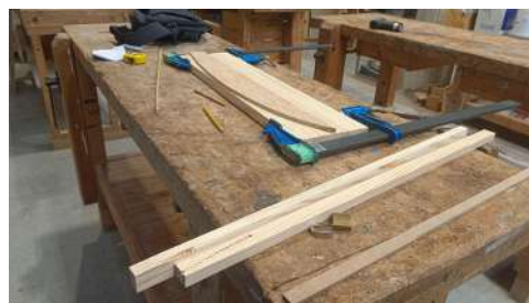
Figura 23: Marcatge de la silueta de la taula en els llistons (elaboració pròpia).
