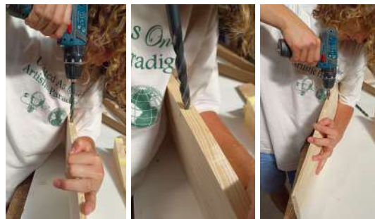
Figura 25: Procés de foradar (esquerra), xanfrar (mig) i caragolar (dreta) 37 (elaboració pròpia).
