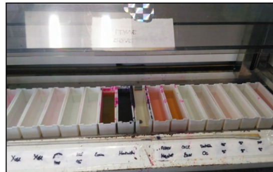
Figura 71: Interior màquina de tinció amb els alcohols i tints.
