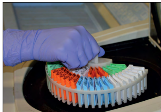
Figura 60: Col·locació dels cassettes a la màquina de deshidratació.
