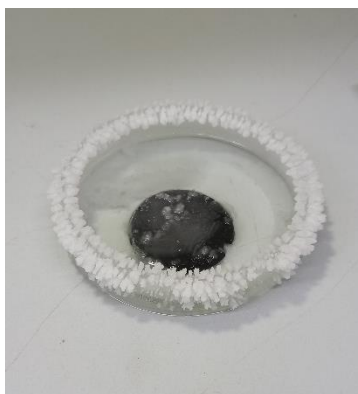
Figura 35 - Imatge del superconductor submergit en cloroform líquid. Els cristalls al voltant de la placa de petri són de cloroform sòlid, que encara no s'ha fos. Font: imatge pròpia.
