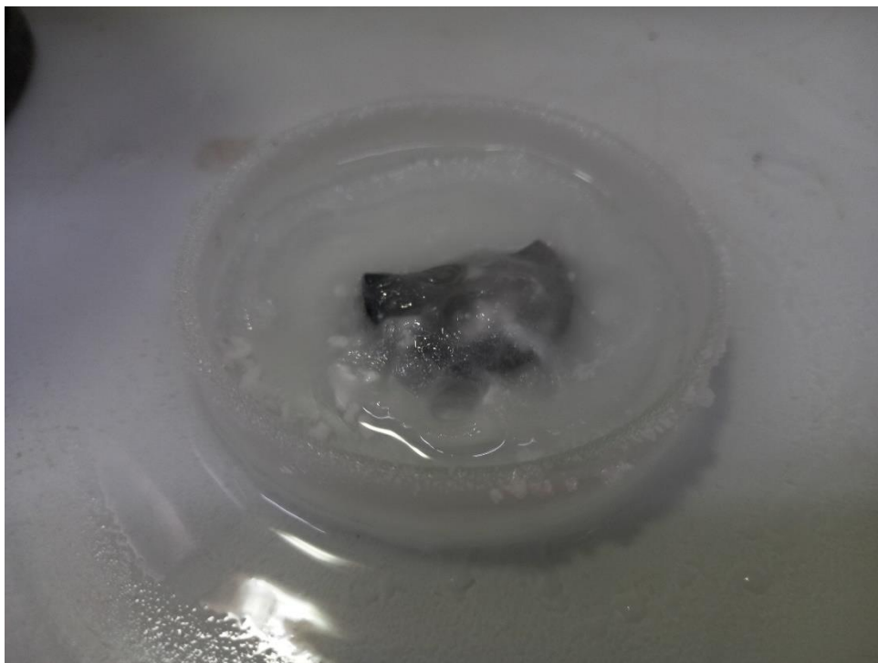
Figura 36 - Superconductor dins l'hexà sòlid. L'hexà es veu poc perquè és majoritàriament transparent, i es pot començar a veure com es fon. Font: imatge pròpia.
