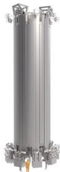
Figura 25 - Representació de l'imant solenoide de l'ITER. Font: Organització ITER, https://www.iter.org/mach/magnets
