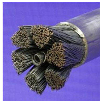
Figura 22 – Imatge d'un dels cables emprats per la construcció dels imants de l'ITER. Font: Organització ITER, https://www.iter.org/mach/magnets
