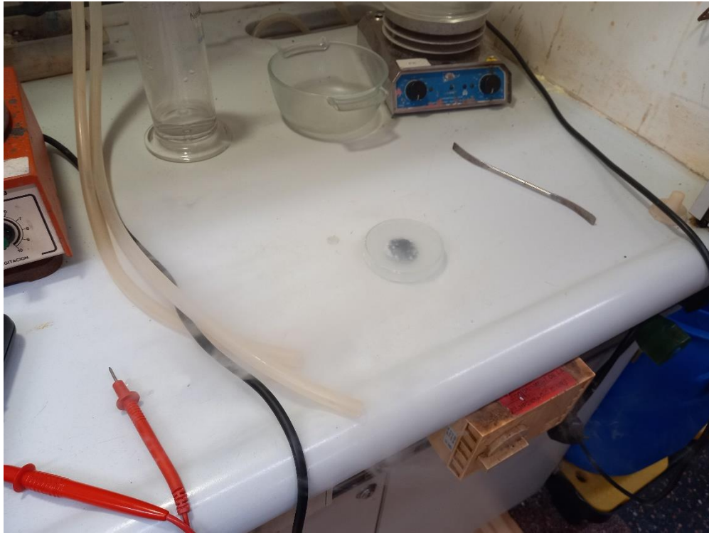
Figura 37 - Imatge del superconductor després de submergir-lo en nitrogen líquid. Es pot observar si es para atenció el vapor de nitrogen que cau de la taula. Font: imatge pròpia.
