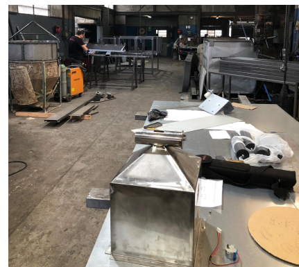
Figura 26: Tremuja i Cilindre Distribuïdor al taller del ferrer Font: Fotografia feta per l'autor
