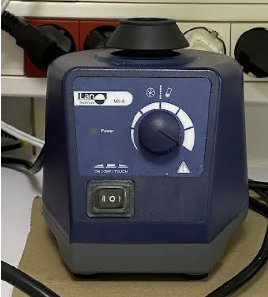
Imatge 34: Apareix un agitador, on després de abocar a un tub d'assaig la mostra de sang i els marcadors l'agitavem en aquesta màquina. (font pròpia)
