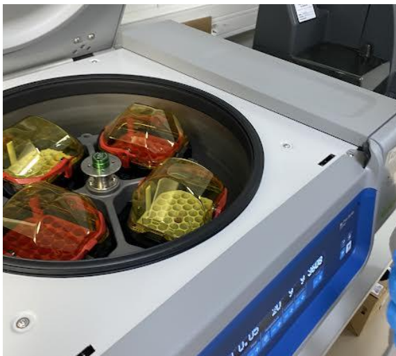
Imatge 35: Aquesta màquina sereix per centrifugar la mostra de sang amb els marcadors corresponent. (font pròpia)
