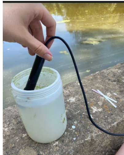
Figura 2: Mesura oxigen Ser, curs baix (Imatge pròpia).
