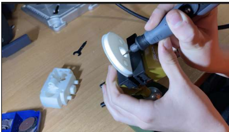
Fig. 34: Modificació d'una peça amb la Dremel 3000
