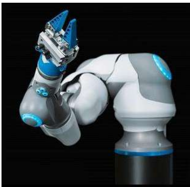
Fig.52. Braç robòtic FESTO, amb motors pneumàtics.
