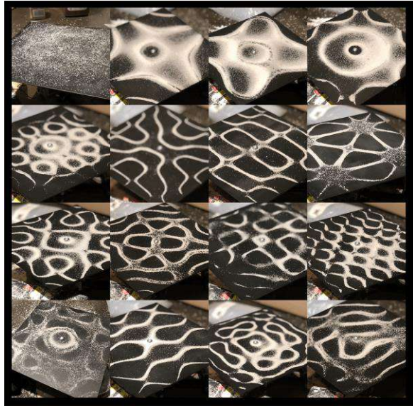
Figura 2.10: Diversos modes de vibració d'una placa de Chladni quadrada. (Font: Chladni Plate // Pensar.com)
