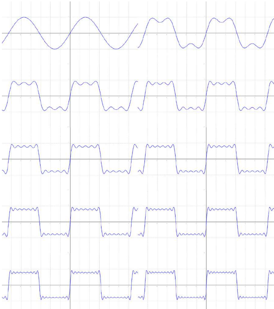
Figura 4.20: Procés de formació de l'ona quadrada a partir de la suma de les seves ones sonores sinusoidals. (Font pròpia).
