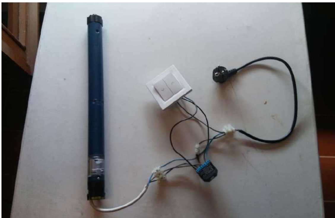
Figura 21: Motor tubular automatitzat amb el Shelly.
