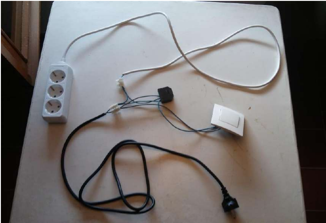
Figura 17: Multitoma automatitzat amb el Shelly.
