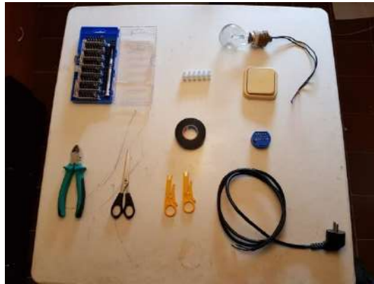
Figura 6: Materials per a l'automatització d'una bombeta.
