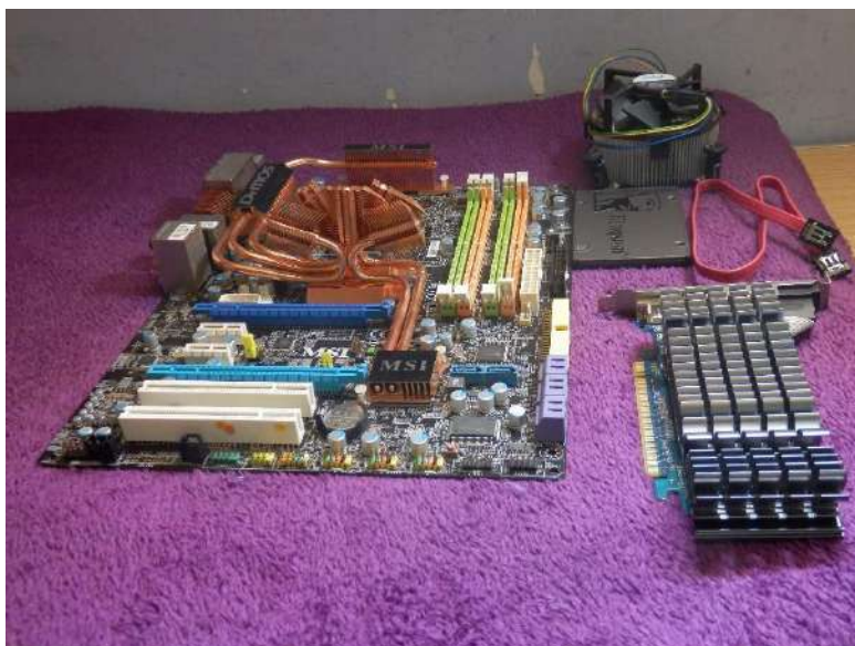
Imatge 117: Altres materials sense molta importància com un petit dissipador, un disc dur, o una gràfica, ja que les plaques del chipset P45 no tenen entrada d'imatge. Tots aquests els vaig reutilitzar d'altres equips que tenia a casa.
