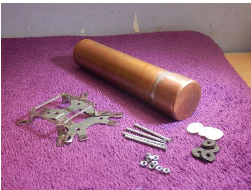
Imatge 118: Pot o container d'overclocking de coure pur, ja que és el millor conductor tèrmic accessible, el vaig construir a partir d'un tap coure amb una tubària de la mida corresponent. I uns ancoratges que vaig reutilitzar d'un altre dissipador que encaixaven a la perfecció. El vaig construir jo mateix, ja que el cost d'aquest va ser d'uns 30€ mentre que els que compren els overclockers professionals preparats per la seva utilització solen costar més de 300€.
