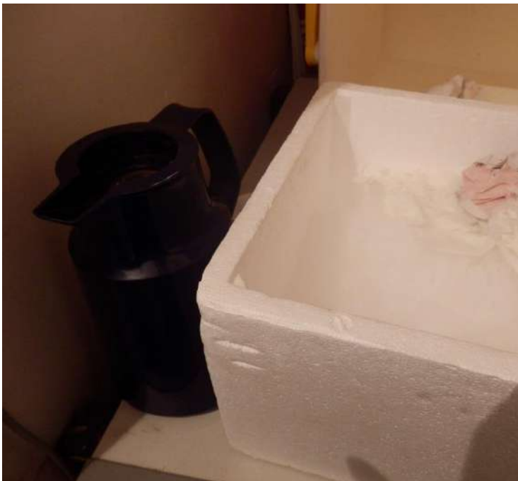
Imatge 122: El gel sec pròpiament i un recipient, un termo per portar el material des del porexpan on es troba emmagatzemat fins a la zona de proves. També és imprescindible usar guants per manipular el gel directament.
