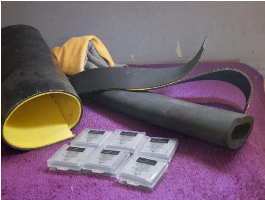
Imatge 119: Material d'aïllament per protegir els components de les baixes temperatures i la condensació que aquestes provoquen. Eraser i Armaflex bàsicament.
