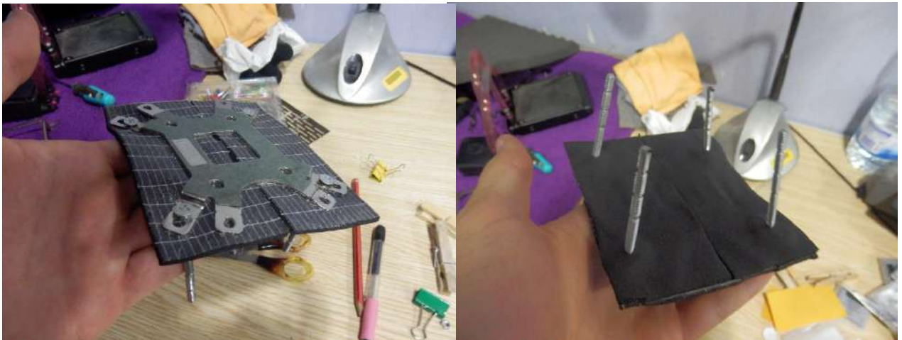
Imatge 123: Aïllament dels ancoratges del processador de la part posterior de la placa amb Armaflex.
