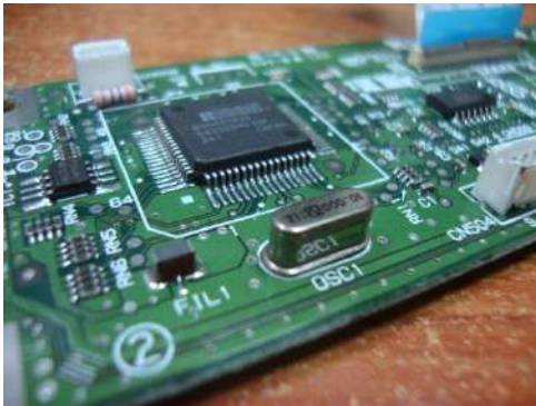
Imatge 11: Primer pla dels primers dos elements principals que determinen la freqüència, l'oscil·lador de cristall en la part central inferior de la imatge i el circuit Phase-Locked Loop (PLL) just sobre d'aquest.
