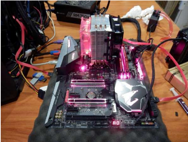
Imatge 100: Comprovació de la funcionalitat dels components abans de començar el muntatge.
