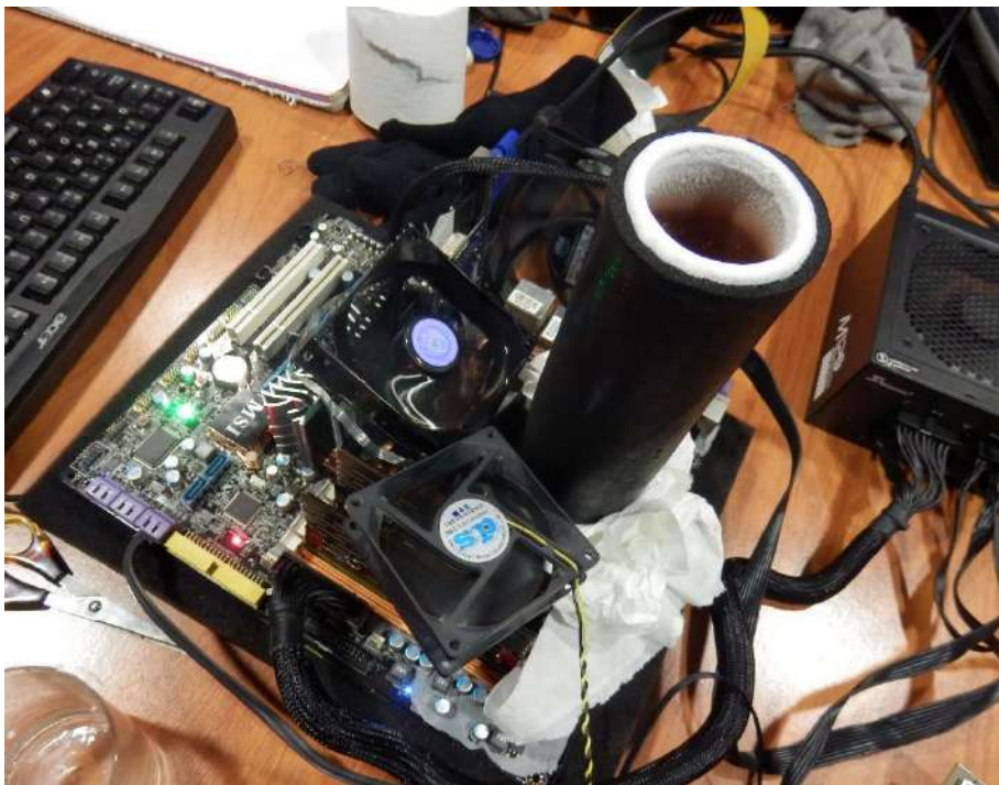
Imatge 73.- Equip refrigerat amb gel sec. (Refrigeració personal de l'autor del treball desenvolupada a la part pràctica.)
