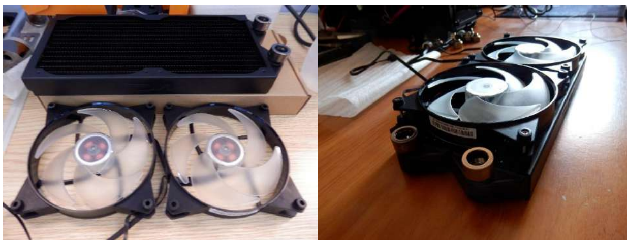
Imatges 80 i 81: Dissipador de 280x140mm amb els seus dos ventiladors de 140mm de pressió d'aire que vam adquirir.
