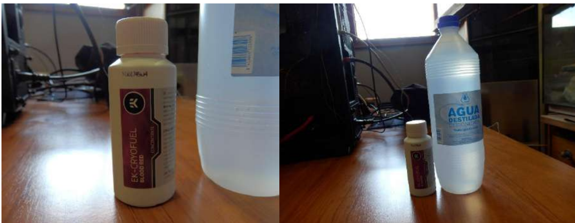
Imatges 90 i 91: Concentrat de líquid refrigerant específic per aquesta tipologia de refrigeracions i 1L d'aigua destil·lada la qual s'ha de barrejar amb el concentrat per obtenir el líquid final.
