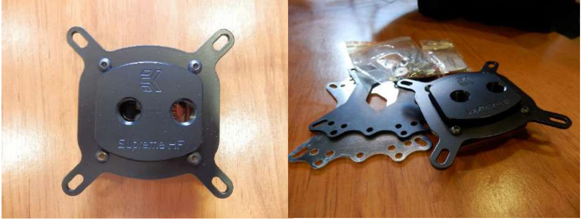
Imatges 82 i 83: Bloc de la CPU i els seus ancoratges corresponents.
