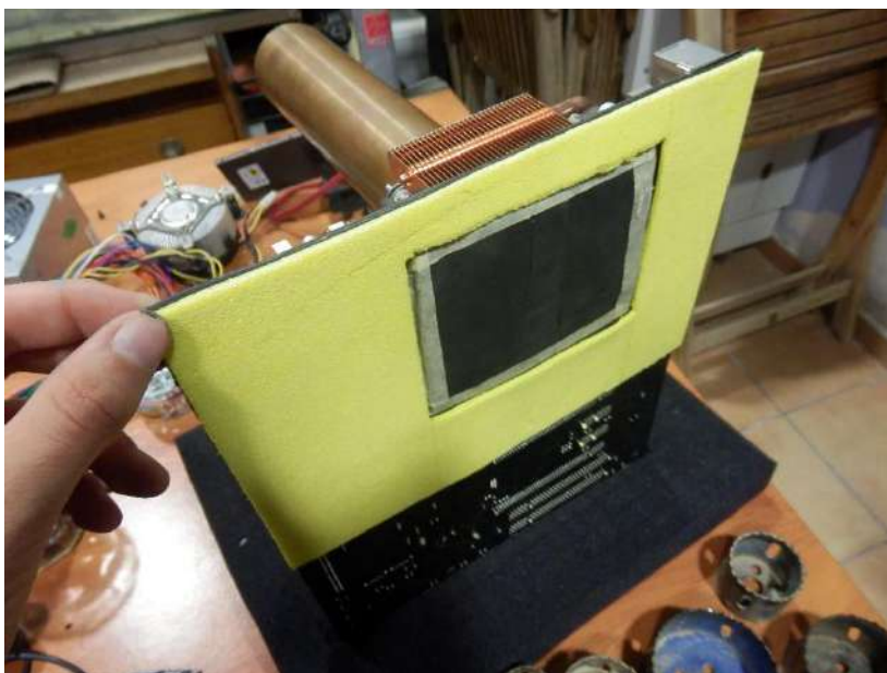
Imatges 124 i 125: Aïllament del chipset mitjançant l'Eraser i l'espuma corresponent.
