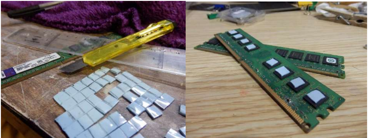
Imatge 128 i 129: Per al muntatge d'un sistema de refrigeració per RAM que vaig idear, vaig tallar el thermal pad (mena d'adhesiu que d'alta conductivitat tèrmica) en les mides corresponents a les memòries i les vaig col·locar al lloc corresponent.
