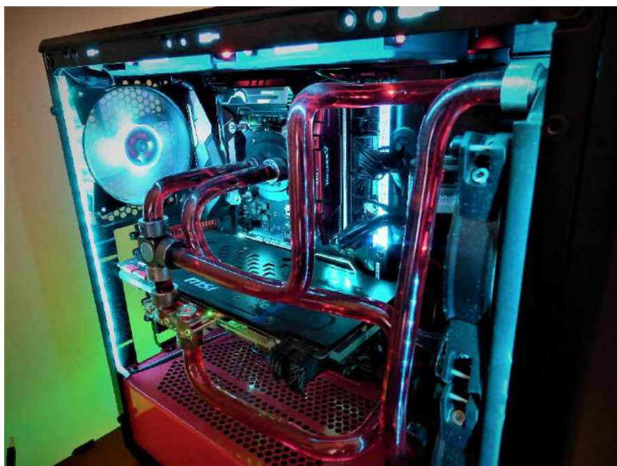
Imatge 70: Refrigeració líquida custom que refrigera tant el processador com la gràfica. (Refrigeració de l'autor del treball desenvolupada a la part pràctica.)
