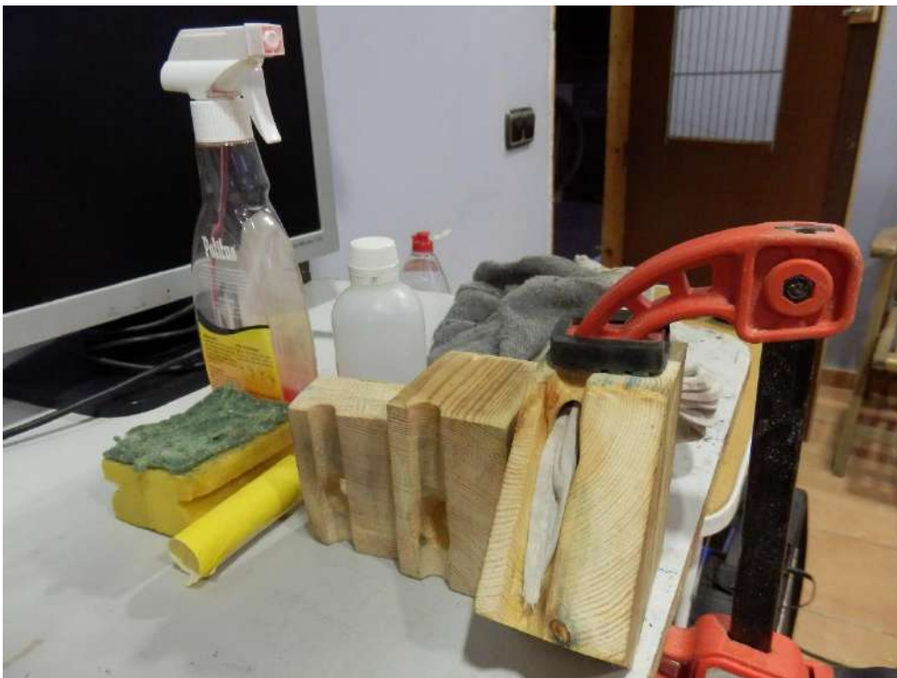
Imatge 103: Després de realitzar els forats i els talls, polir-los fins al més mínim detall. El resultat son tres moltes, dos de 90° amb corbes més tancades o menys i un de 45° per altres tipologies de corbes.
