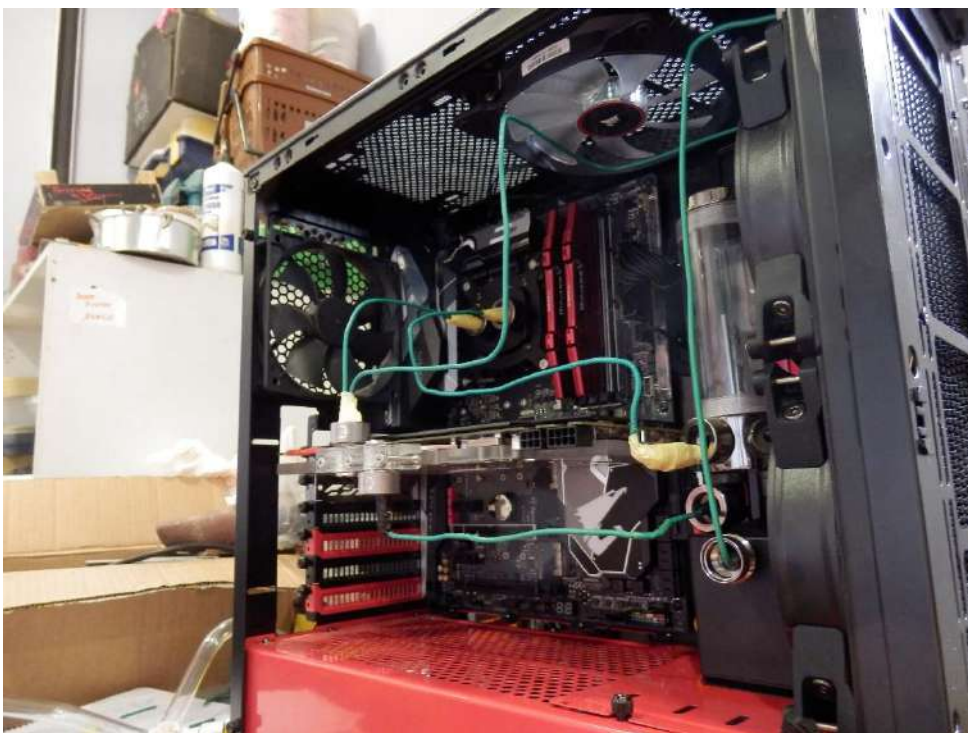
Imatge 105: Per poder saber exactament la mesura de cada tub del circuit vam decidir col·locar uns filferros al lloc d'aquest de manera que després els podíem extreure, mesurar-los i modelar un tub pràcticament igual. (idea personal)
