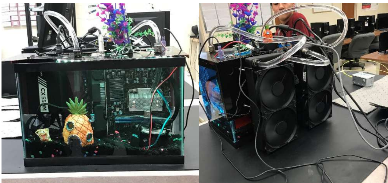
Imatge 71: Sistema d'alt rendiment submergit en oli mineral per Linustechtips, l'autor va adaptar-li un sistema de refrigeració custom per refrigerar la temperatura de l'oli submergit, no obstant les temperatures resultats no van ser molt exitoses.
