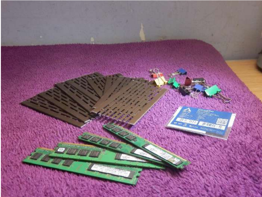
Imatge 121: Memòria RAM i els components necessaris per a un sistema de refrigeració que vaig enginyar perquè les seves temperatures no fossin un problema.
