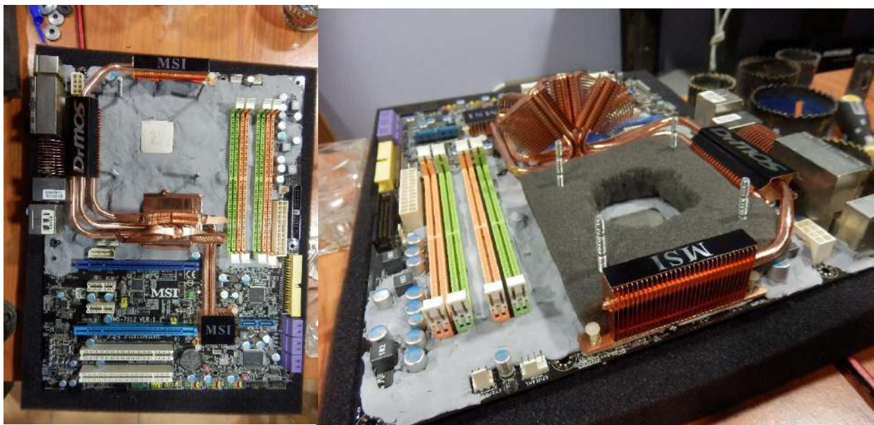
Imatges 124 i 125: Aïllament del chipset mitjançant l'Eraser i l'espuma corresponent.
