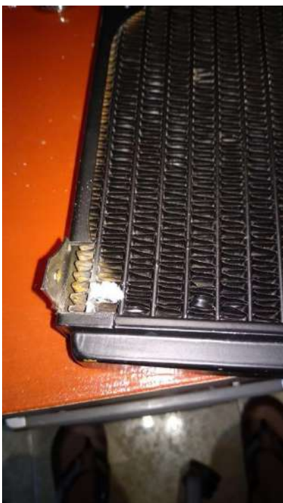
Imatge 109: Cantonada del radiador que va quedar danyada, amb la xapa oberta i el forat de sota soldat.
