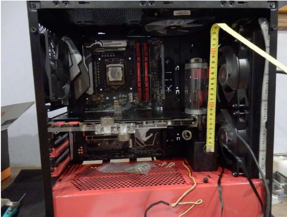
Imatge 104: Vam procedir a muntar els components possibles a la caixa per veure que el plantejament sigues correcte i totes les mides encaixessin.
