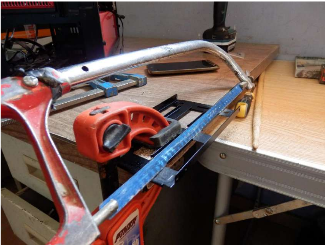
Imatge 108: Serratge d'una badia del disc dur que era un obstacle per la líquida.
