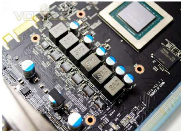
Imatge 30: Components del VRM de la targeta gràfica MSI GeForce GTX 970 Gaming 4GB, encarregant d'alimentar el nucli i les memòries de la GPU.
