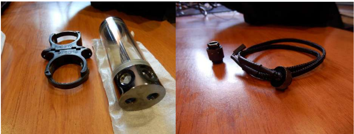
Imatges 86 i 87: Bloc del circuit i un sensor en forma de tap per poder observar la temperatura del líquid dintre d'aquest.
