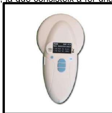
Figura 30: Detector de xips. Aparell de butxaca que es pot utilitzar per ovins, bovins, porcins, etc.
