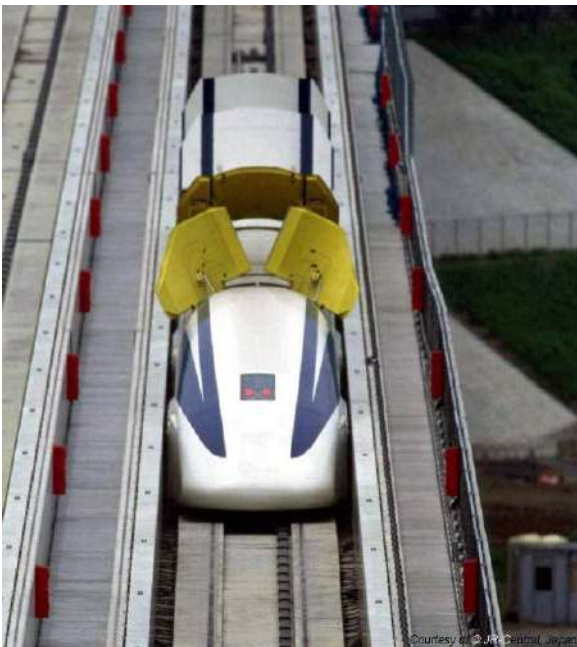
Fig. 19 [18] - Prototip de tren Maglev utilitzant els frens aerodinàmics en una prova de frenada d'emergència extrema.
