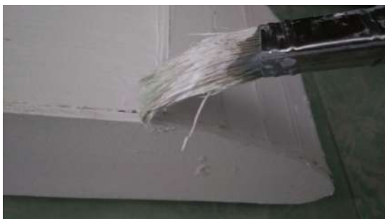
Fig. 44- Imatge de la primera capa de pintura blanca del tren.
