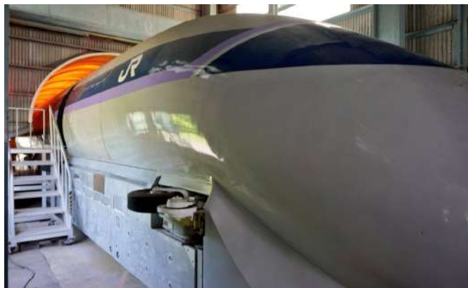
Fig. 20 [19] - Imatge del Tren MLU002N on s'aprecien les rodes laterals per controlar la distància. També es poden observar les plaques dels electroimants al lateral.
