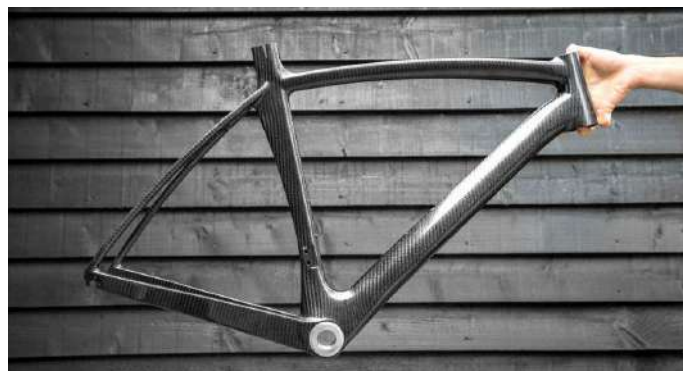
Fig. 23 [22] - Quadre de bicicleta fet de grafè, amb un pes de només 350g.
