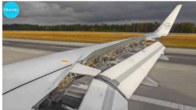
Fig. 18 [17] - Imatge dels "spoilers" d'un Airbus A320-200SL activats durant l'aterratge.
