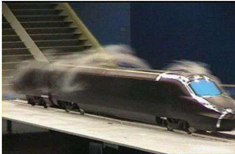
Fig. 22 [21] - Model a escala d'un tren (no és Maglev) al túnel del vent per analitzar-ne el comportament aerodinàmic i fer-lo més eficient.
