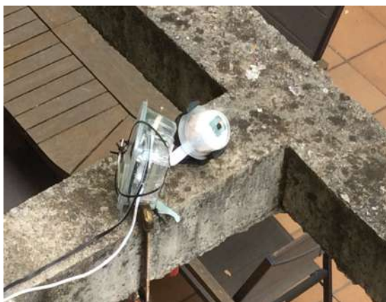
Imatge 5.4: Muntatge de protecció per a la Raspberry Pi. Font: pròpia
