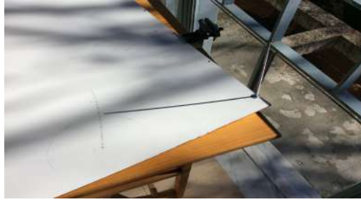
Imatge 6.8: Muntatge per a determinar la latitud experimentalment. Font: pròpia
