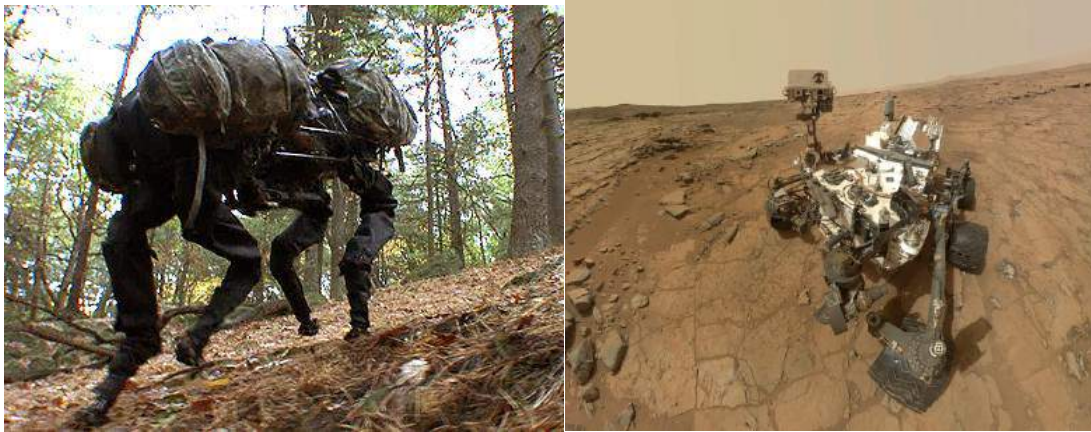
Fig. 2 i 3: En aquestes fotos podem veure dos tipus diferents d'UGV. A l'esquerra el BigDog i a la dreta el Curiosity, el vehicle que la NASA ha enviat a Mart.
