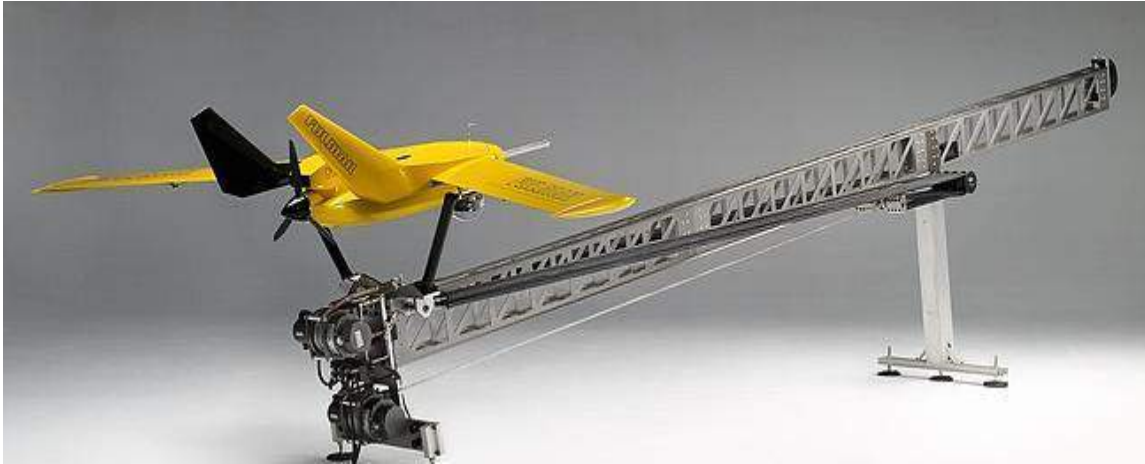
Fig. 44: En la imatge podem veure el Fulmar en la seva plataforma d'enlairament. Aquest color tant intens té com a finalitat poder veure el fulmar sobre l'aigua, ja que sura a sobre d' aquesta superfície.
