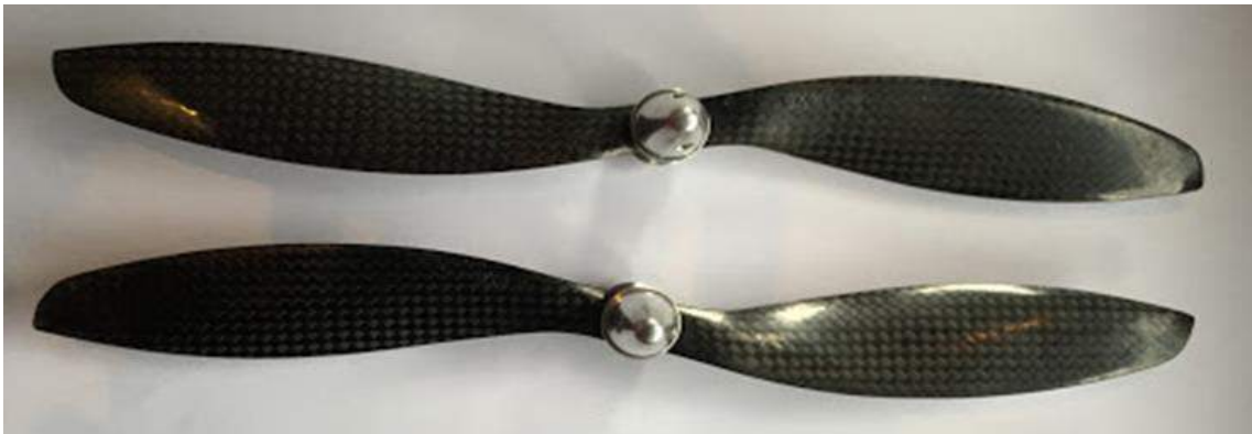
Foto pròpia d'una hèlix CW i una hèlix CCW.
