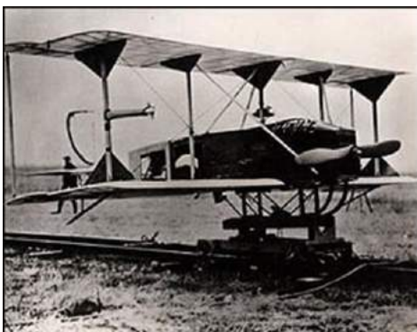
Fig. 10: Imatge del Sperry-Curtiss Aerial Torpedo . Tenia característiques inferiors al dissenyat per Kettering, però les seves dimensions eren més grans.
