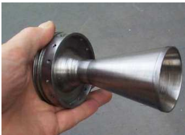
Fig. 5. Tobera de perfil convergent-divergent. Font: www.wikisat.org
