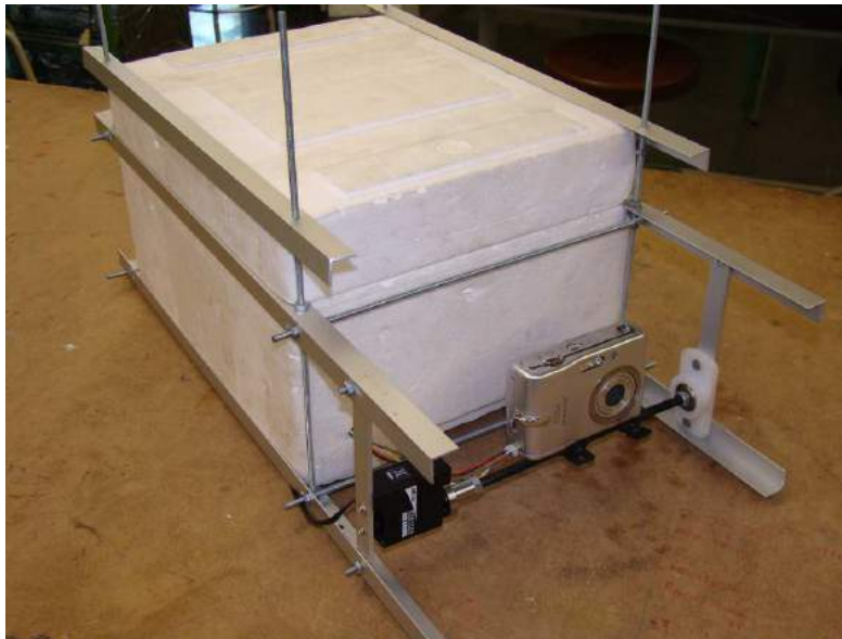
Fig 21. Estructura d'alumini recobrint una sonda estratosfèrica. Font: www.teslabs.com/meteotek08
