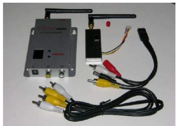
Fig. 44. Equip emissor i transmissor de vídeo d'1,2 W. Font: www.electronicarc.com
