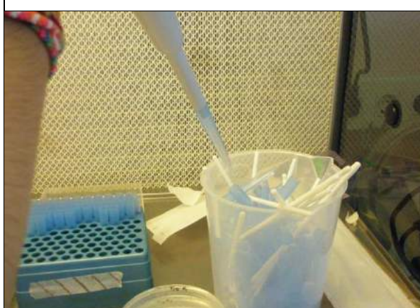
13. Un cop utilitzada la pipeta, la llencem a un recipient amb la resta de pipetes i espàtules que ja s'han emprat. D'aquesta manera evitem el contacte de la pipeta amb diferents dissolucions.
