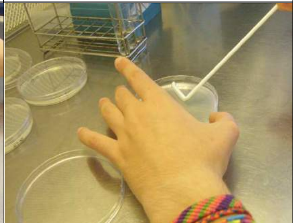
38. Seguim homogeneïtzant la mostra amb molta cura i sempre recordant que s'ha de passar l'espàtula molt suaument i aconseguint que la dissolució quedi repartida uniformament per tota la placa.
