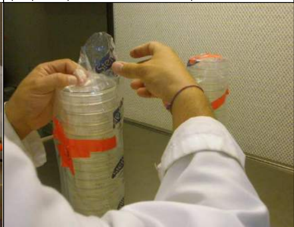
42. Un cop ja s'ha solidificat la dissolució sobre del PCA-Agar col·loquem 20 plaques de Petri en vertical i les embolcallem amb el plàstic que les envoltava a l'inici.
