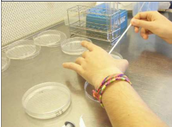
37. Obrim la tapa de la placa de Petri i amb l'ajuda d'una espàtula homogeneïtzem la mostra.
