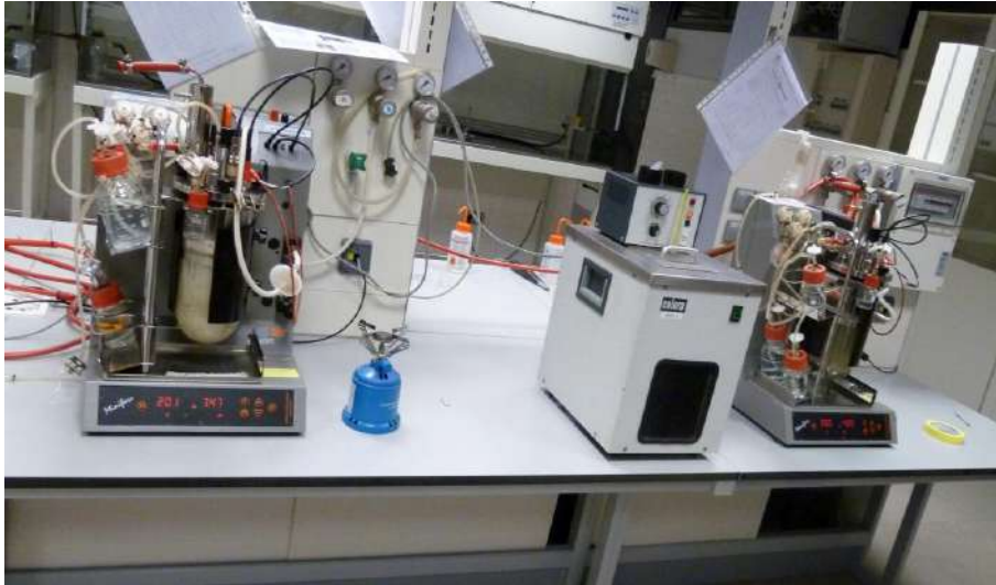
Font: pròpia. Imatge de dos reactors. En tot disseny experimental es necessita una prova control, en aquest cas és el reactor de l'esquerra que conté glicerol normal (de no rebuig). El de la dreta conté glicerol de rebuig. Els podem diferenciar pel color, el de la dreta que és més indica que és el glicerol de rebuig.
