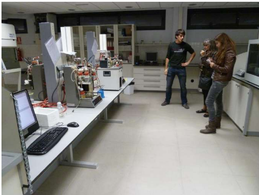
Font: pròpia. Imatge d'un reactor connectat a l'ordinador. Pel monitor es pot dur un control dels paràmetres, que s'han de mantenir constats, i rectificar si cal.
